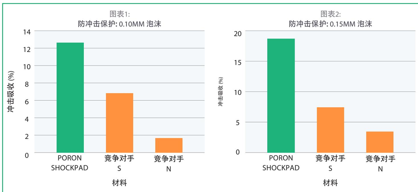
PORON ShockPad 0.10mm 和 0.15mm材料不仅吸收巨大的冲击力，同时具有极佳的抗压缩形变。此外加工方便，在终端产品的整个生命周期始终表现可靠。想要了解更多，请访问网址：[Rogerscorp.com/ShockPad](http://Rogerscorp.com/ShockPad)或者联络您当地的销售代表。
